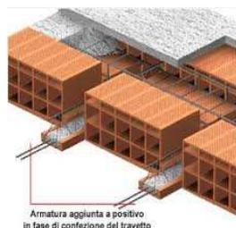
L'altezza è idonea a garantire una portata utile pari al carico permanente ed accidentale previsto per tali locali, oltre al peso proprio; i calcestruzzi usati avranno le stesse caratteristiche di quelli descritti al punto n° 7.
